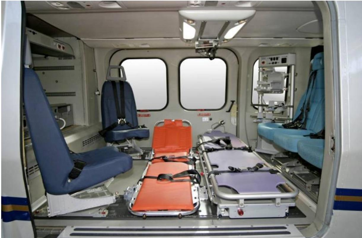
**Figure III. 5 :** Exemple d'une configuration (civiers et chaises) de la cabine de l'AW139.
