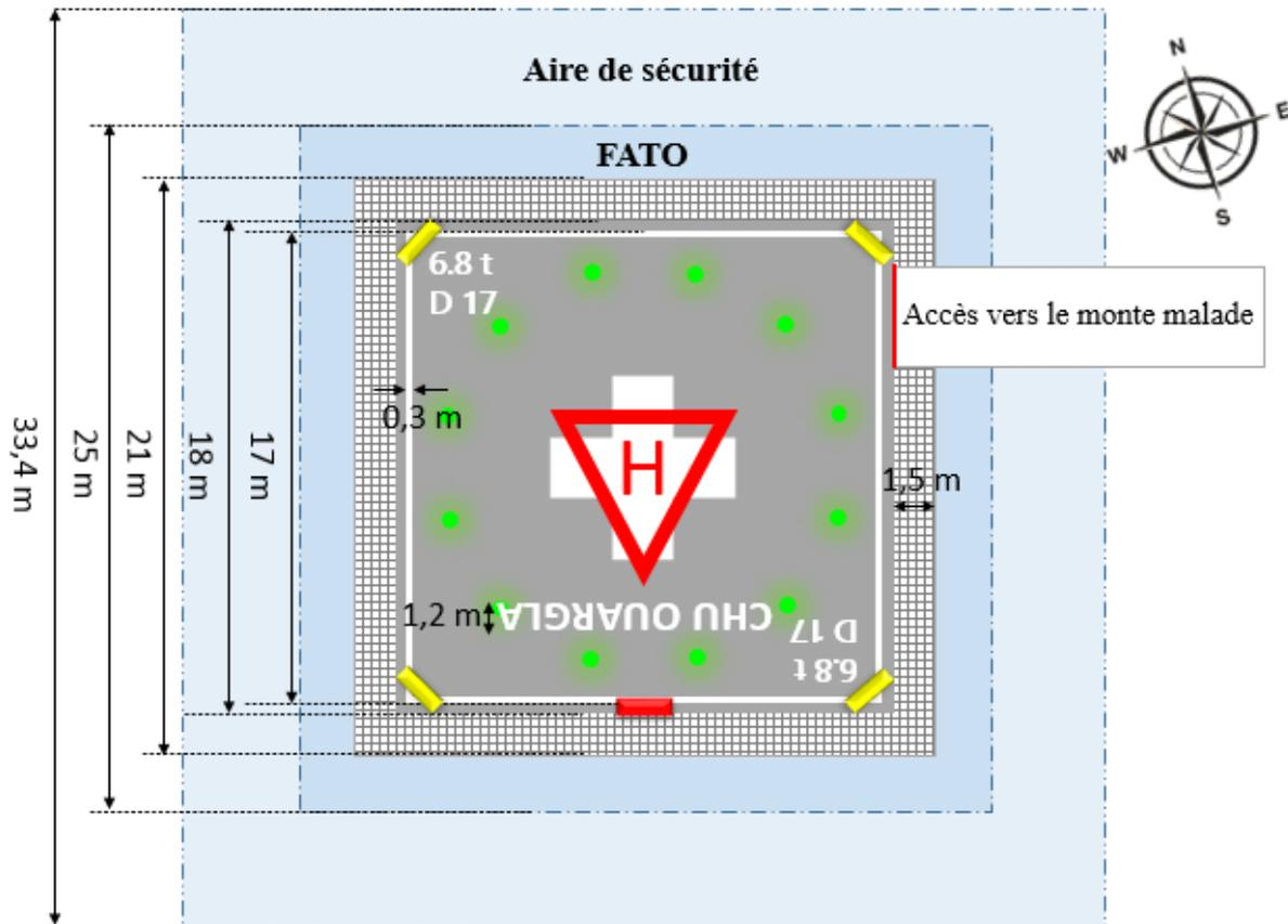
**Figure III. 6 :** Dimensions de l'hélistation en terrasse.
