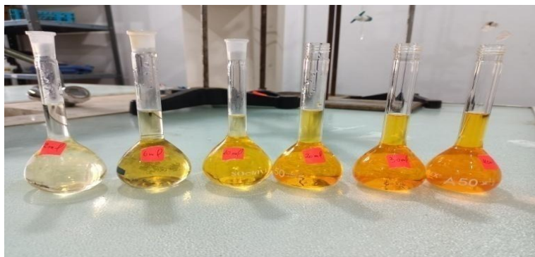
Figure 5.16 : Solution fis de méthyle orange de 1, 5, 10, 15, 20 et 25mg/L.
