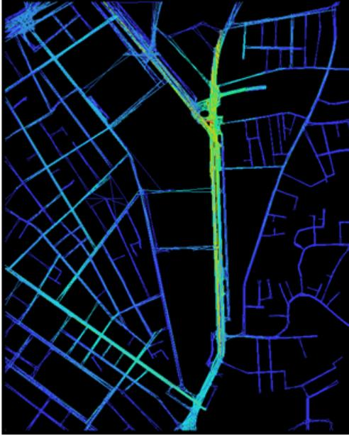
Figure 3 AXIAL MAP : PATH LENGTH Source : Auteur, Logiciel : DEPTHMAP
