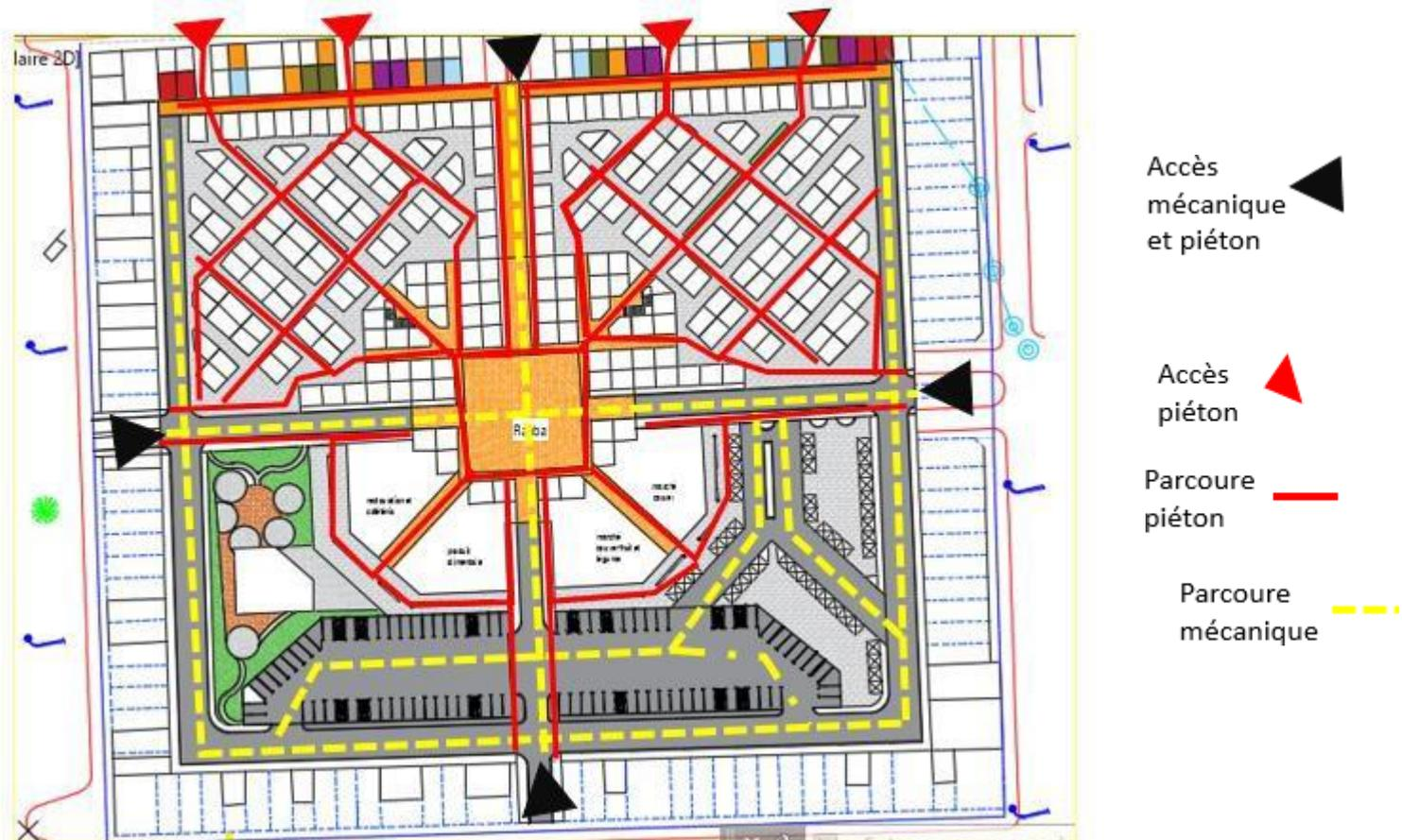
Figure 83 : Accessibilités mécanique et piétonne.
