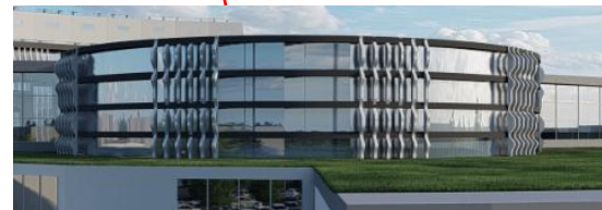
Figure 73 : Protection par éléments horizontaux pour atrium .Source : Auteur
