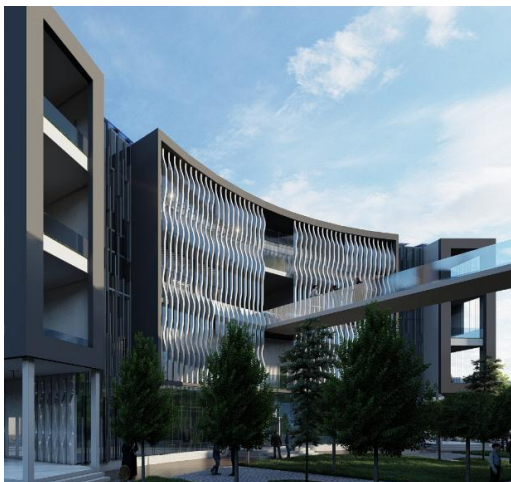
Figure 71 : Façade double peaux. Source : Auteur
