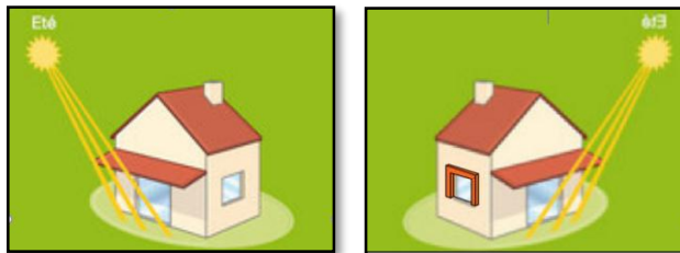
Figure 48 :Schéma d'utilisation des brises soleil. Source : Conseils-thermiques.org
