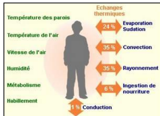
Figure 9 Paramètres du Confort thermique source: energieplus-lesite.be/theories/confort11/le-confort-thermique-d1/
