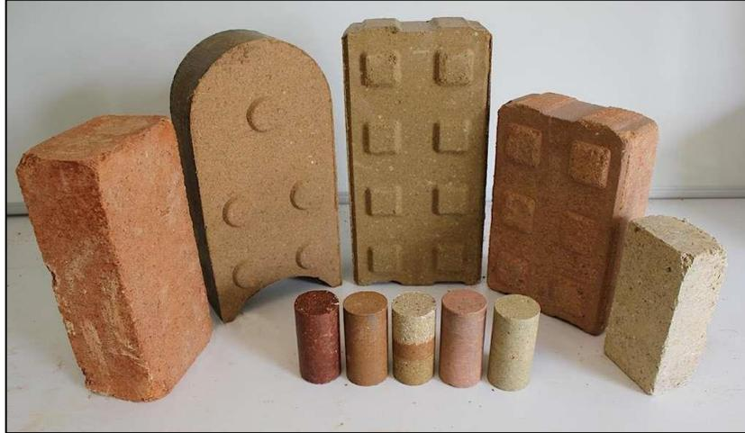
*Figure III-74 : Brique de terre compressée.*
