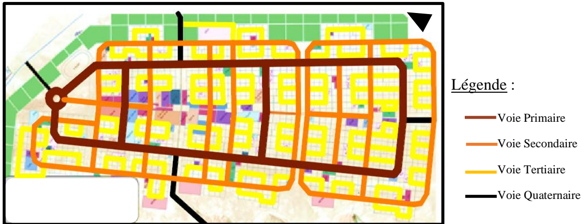
Figure III-27: Schéma de l'hierarchisation du réseau viaire de la ville Nouvelle. Source : Egis. (2012). Traitée par Auteurs 2022.
