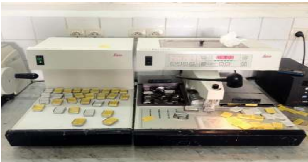
Station d'enrobage Leica
