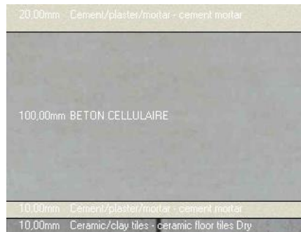
coupe sur parois intérieur humide
