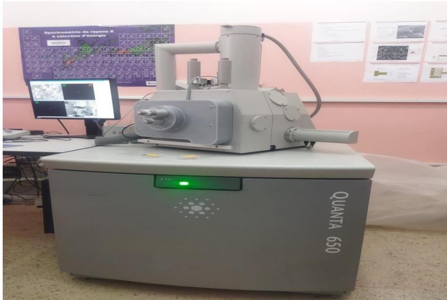
**Figure 3.6 :** Microscopie électronique à balayage MEB ( Quanta 650)
