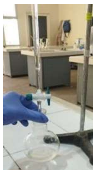
Photo III.1 : Montage de la réaction Saponification (a) et Le titrage de l'excès de potasse (b) .
