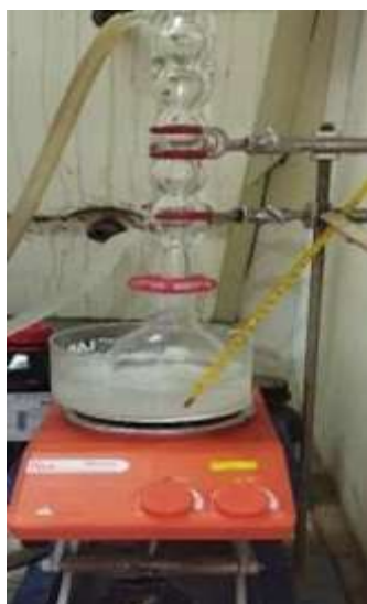
Photo III.1 : Montage de la réaction Saponification (a) et Le titrage de l'excès de potasse (b) .
