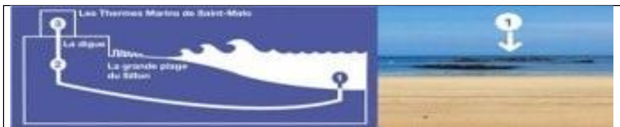
Figure 93: schéma de cheminement de l'eau de mer au centre de thalassothérapie à saint-malo
