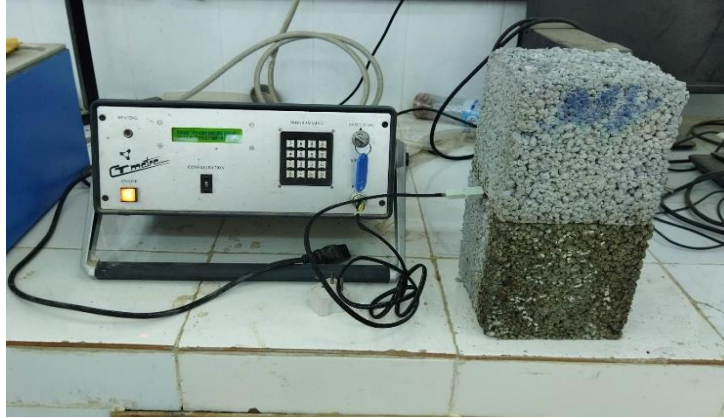
Figure 2.7: Dispositif de l'essai de la conductivité thermique.
