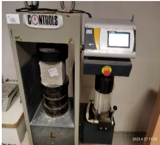
Figure 2.5: Dispositif de l'essai de compression des éprouvettes.
