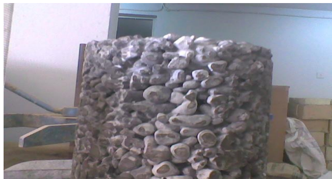
Figure 1.14 : Bloc du béton caverneux. [22]
