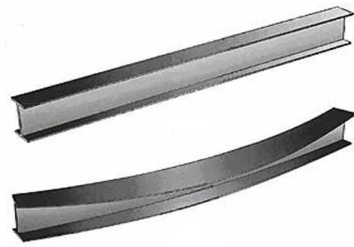
Figure V. 5: Phénomène du déversement
