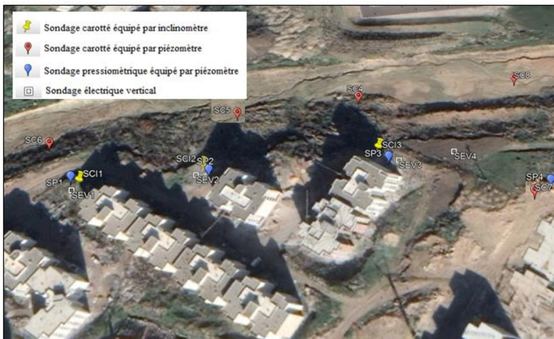
Figure III.17 : Plan d'implantation des essais géotechniques In situ.
