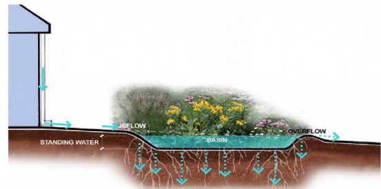
Figure 258: le système de la Phytoépuration pour les plantes des jardins. Source: deavita.fr
