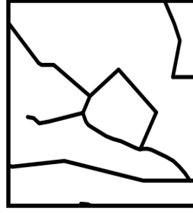
Inclusion d'un système en boucle dans un système arborescent et un système en boucle
