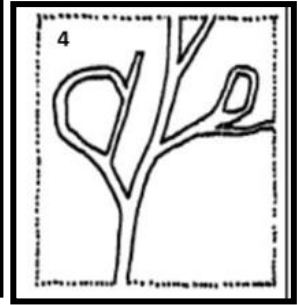
Inclusion d'un système en boucle dans un système arborescent et un système en boucle
