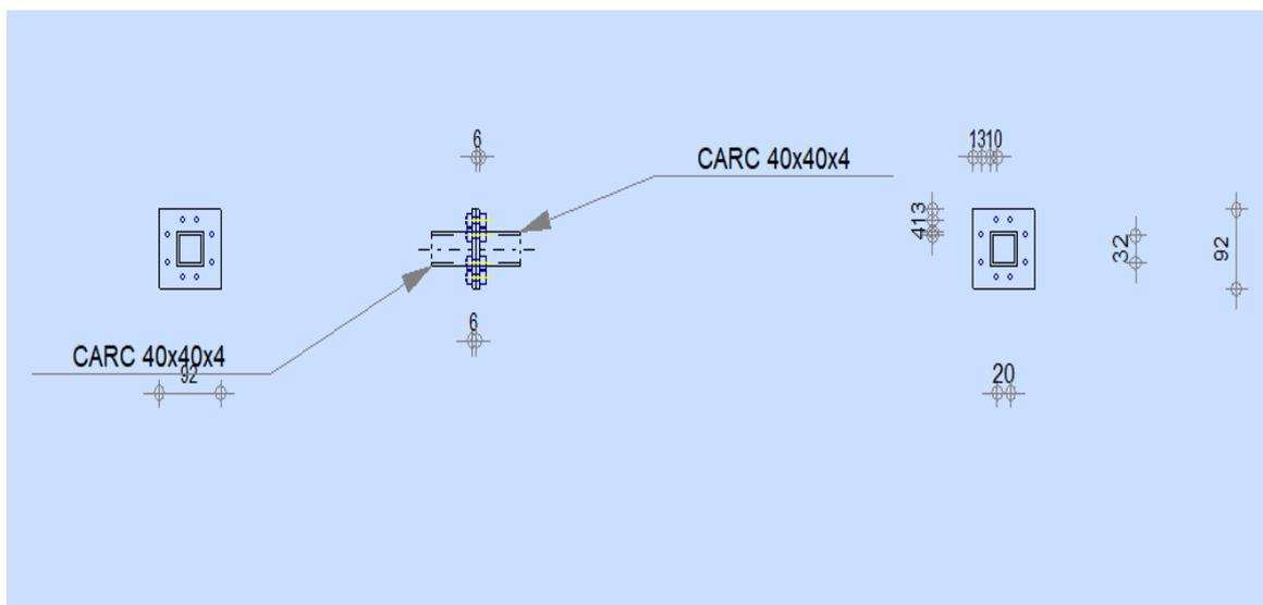
**Figure.11 :** Schéma d'assemblage Diagonale – Diagonale.
