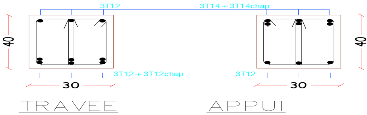
Figure V.7 : Schéma de ferrailage des poutres secondaire
