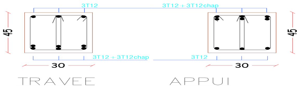
Figure V.6 : Schéma de ferrailage des poutres principale
