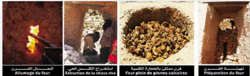
Figure 43 : la préparation de La chaux Source : مواد البناء التقليدية OPVM
