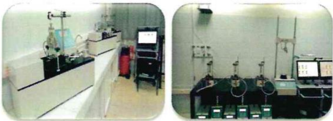
Figure III.11 : Appareillage d'essai de cisaillement.
