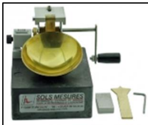
Figure III.9 : Appareil de CASAGRANDE.
