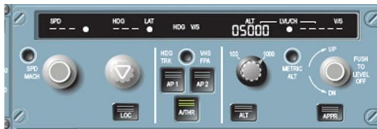
**Figure 3.7.** Interface de commande du PA.
