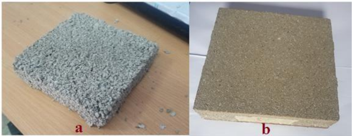
Figure IV.7 : Influence de la pression de mise en œuvre (densité) sur la friabilité des éprouvettes : a) : matériau friable, b) : matériau compact et stable dimensionnellement. b-
