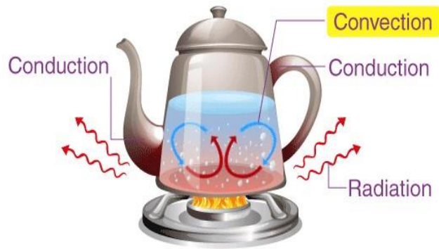
Figure I.4 : Les trois modes de transfert de chaleur [28].
