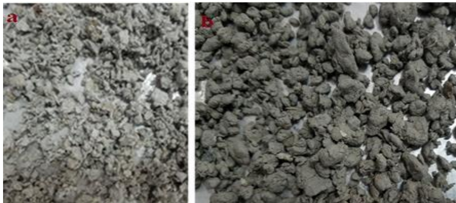
Figure IV.6 : Influence de la sphérification sur la géométrie des particules et sur la teneur en poussière de la pâte à papier : (a) avant, (b) après.
