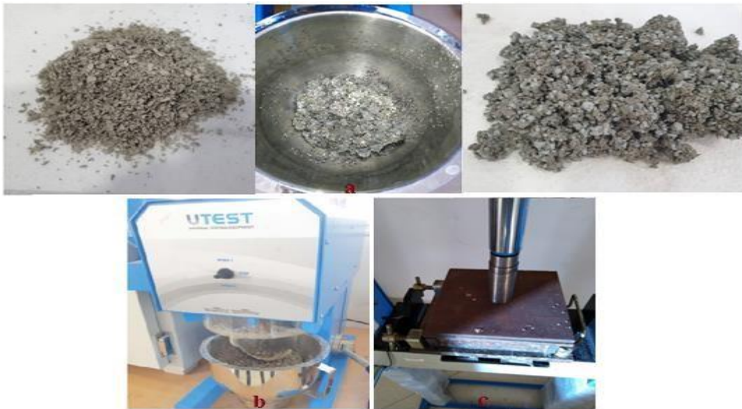
Figure III.1 : Production des composites a) malaxage du liant ; b) malaxage du mélange ; c) compactage
