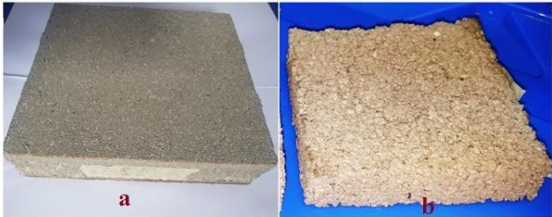
Figure IV.8 : influence de la méthode de séchage sur la qualité des éprouvettes : (gauche) solaire, (droite) étuveuse.
