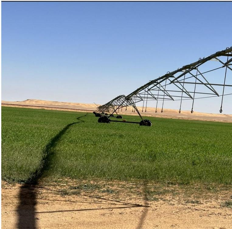
**FigureI.6.Travée de rampe d'arrosage (prise de la station agricole de Méniá)**
