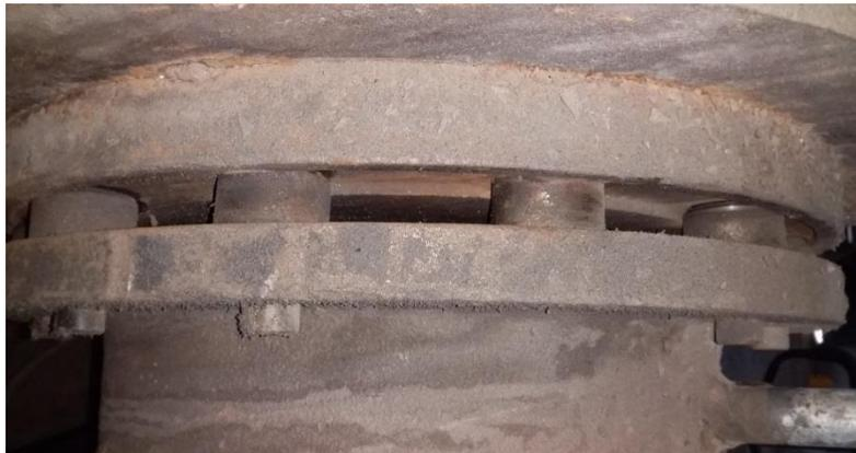
Figure 2-7 : Bagues de correction d'alignement.
