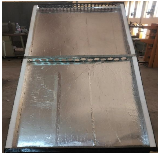
Figure (III.8) : un boîtier extérieur isolée
