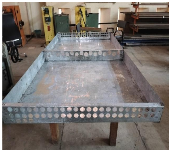
Figure (III.7) : un boîtier extérieur d'un capteur à air.
