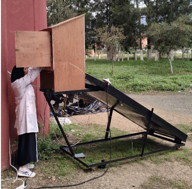
Figure (III.13) : Séchoir solaire indirect actif ou forcé.
