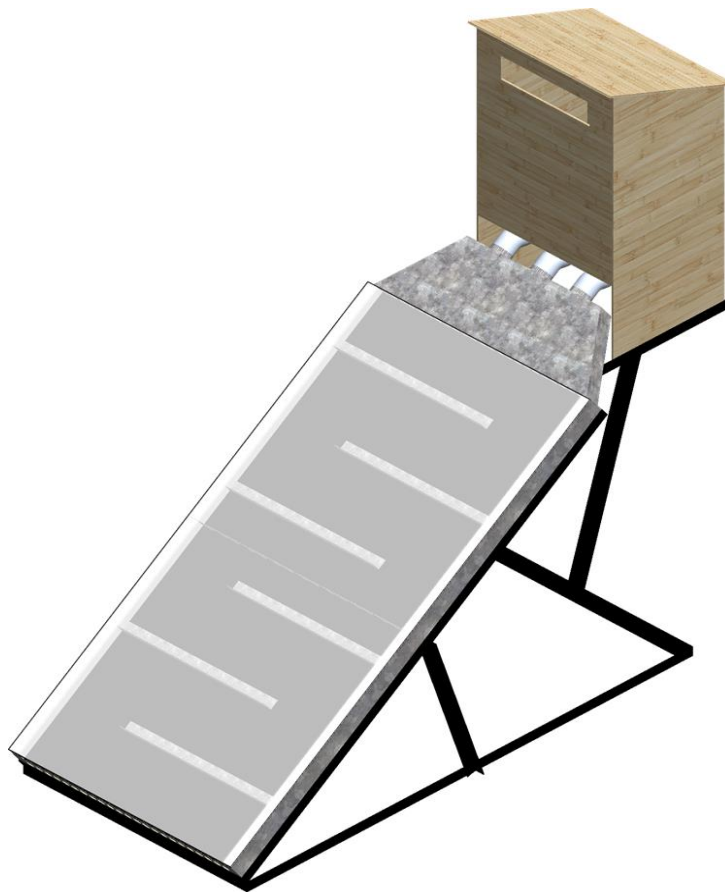
Figure (III.4) : conception un Séchoir solaire indirect forcé.
