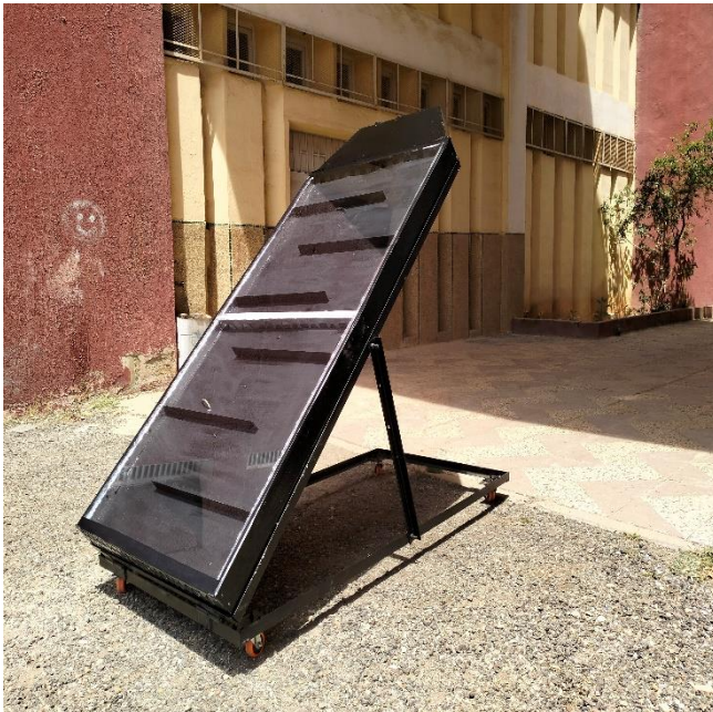
Figure (III.9) : capteur solaire à air
