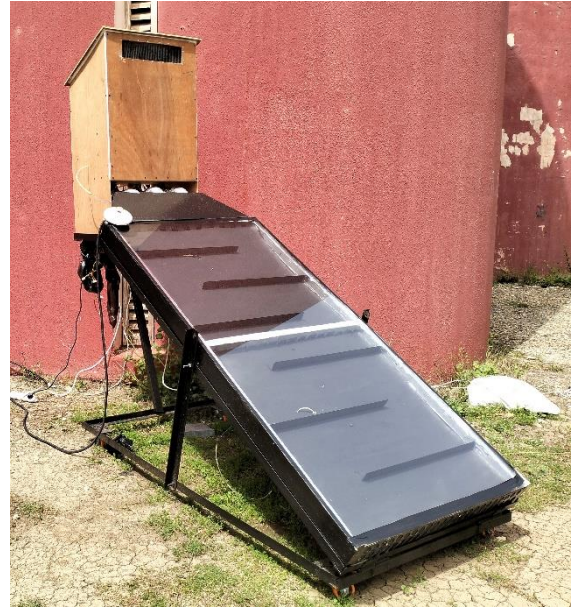
Figure (III.13) : Séchoir solaire indirect actif ou forcé.
