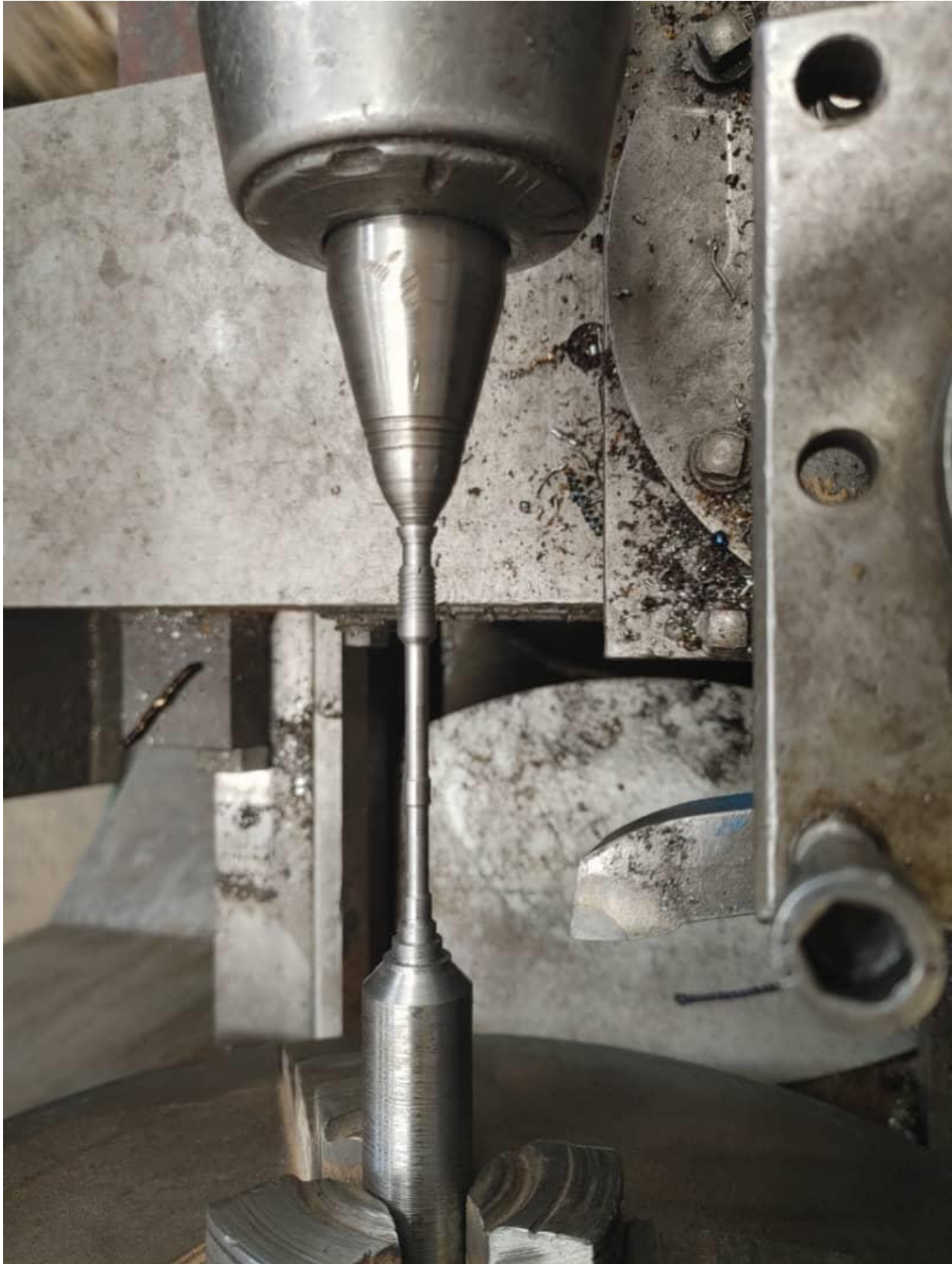
Photo A.4 l'usinage du pin
