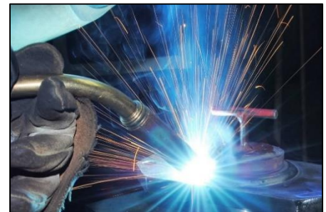
Figure (2.14) procédé du soudage MIG
