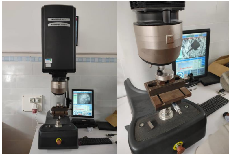
Figure (2.23) Essai de durcissement sur la machine du centre de recherche
