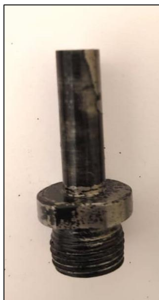
Figure (2.22) le sleeve après trempe
