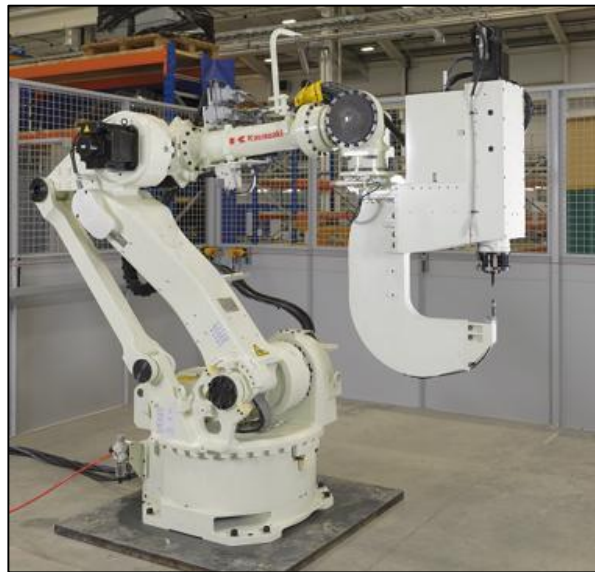
Figure (1.20) La machine RFSSW du type robot d'un fabricant chinois. (40)
