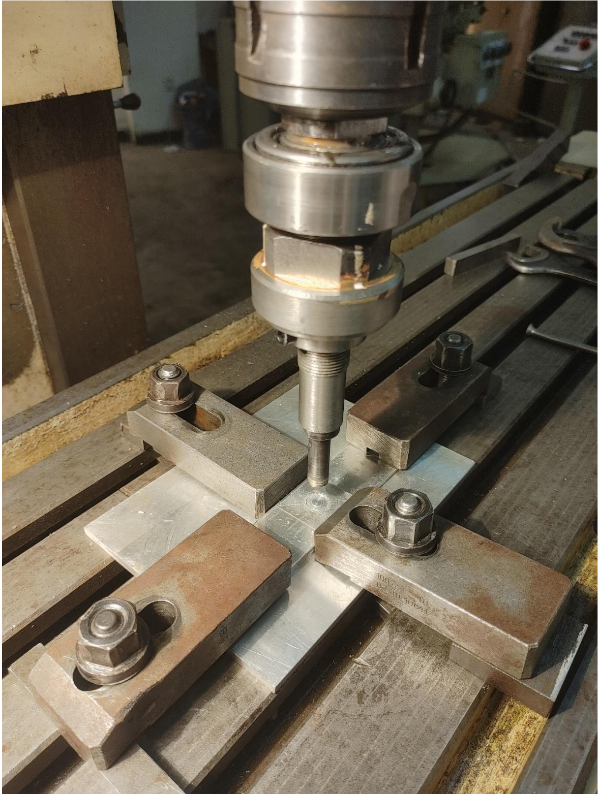
Photo A.3 l'outil monter sur une fraiseuse mécanique
