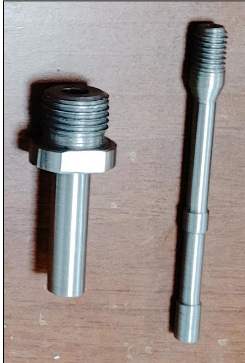
Figure (3.44) le Pin et le Sleeve après réalisation
