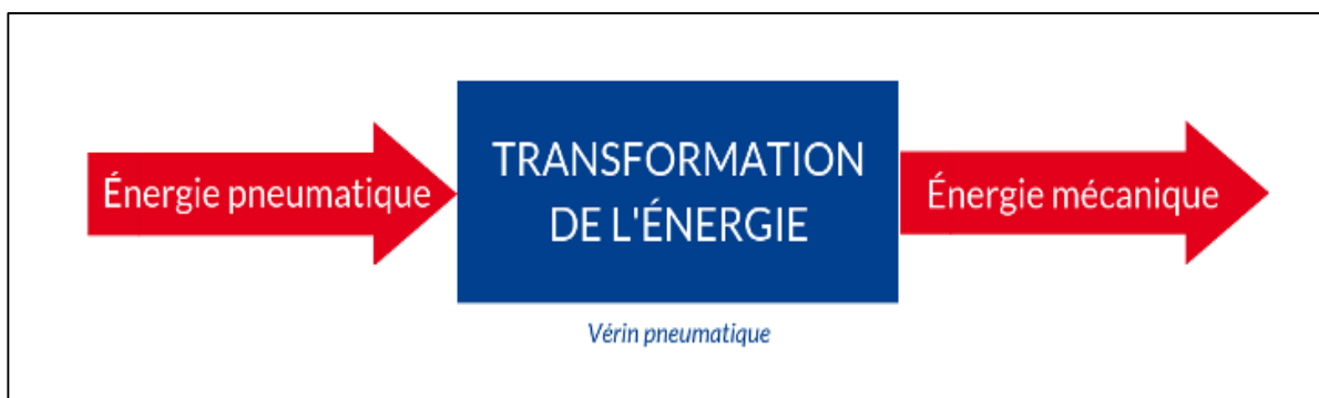
Figure (2.12) schéma explicatif du principe de fonctionnement d'un vérin pneumatique
