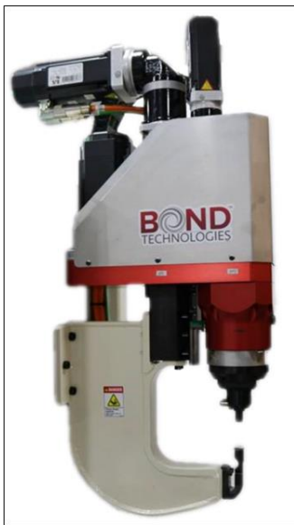
Figure (1.19) Machine RFSSW sous forme fixe du fabricant américain BOND TECHNOLOGIE . (6)
