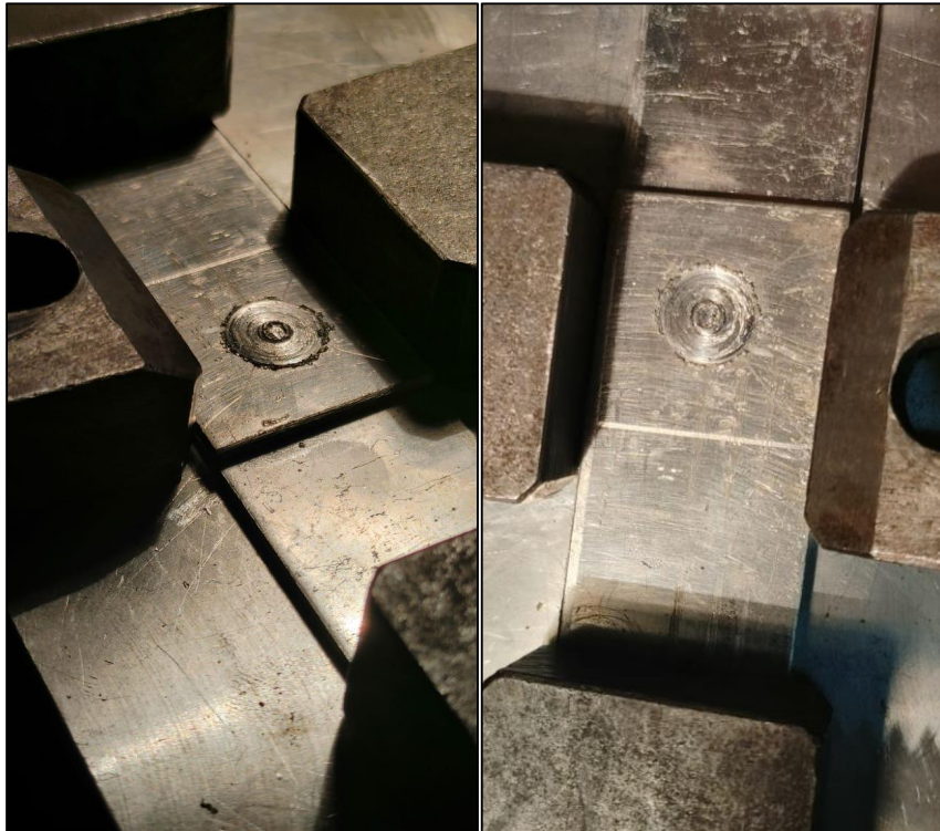
Figure (4.7) la soudure RFSSW réalisé par notre outil
