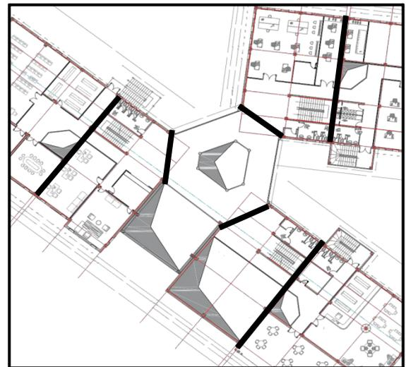
Figure 252 :plan d'emplacement des joint
