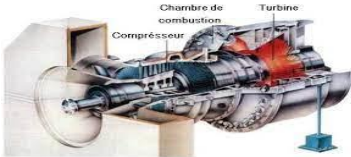
Figure 1.2 : différents organes caractérisant une turbine à gaz [4]
