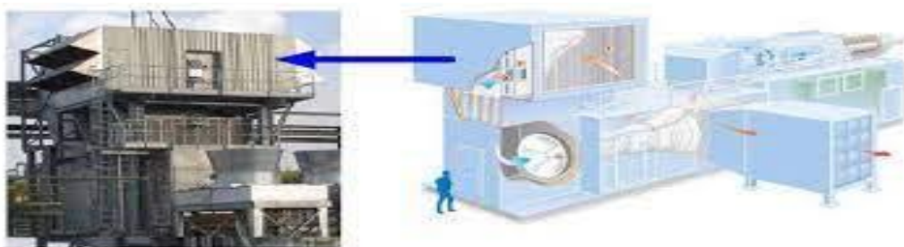
Figure 2.1: chambre de filtration [10]
