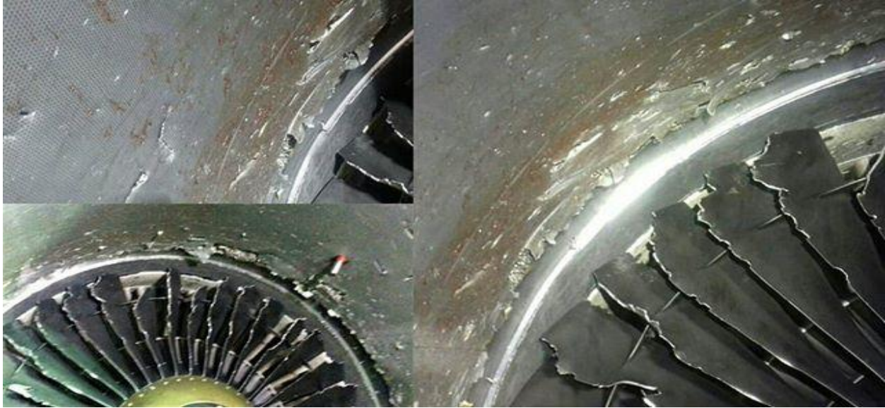
Figure 2.7: Turbine à gaz dommages de FOD
