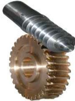
**Figure 1.9 :** Engrenages à roue et vis sans fin
