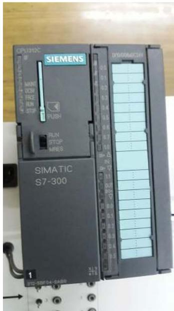
Figure 30 :API du SIEMENSE \_S7-300\_CPU-312
