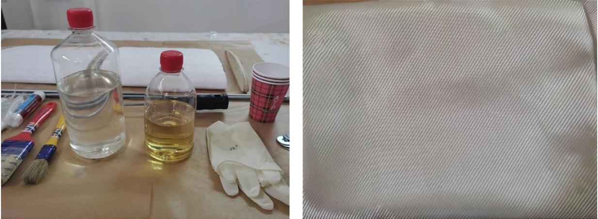
Figure II.12. Résine époxy / fibre de verre.
