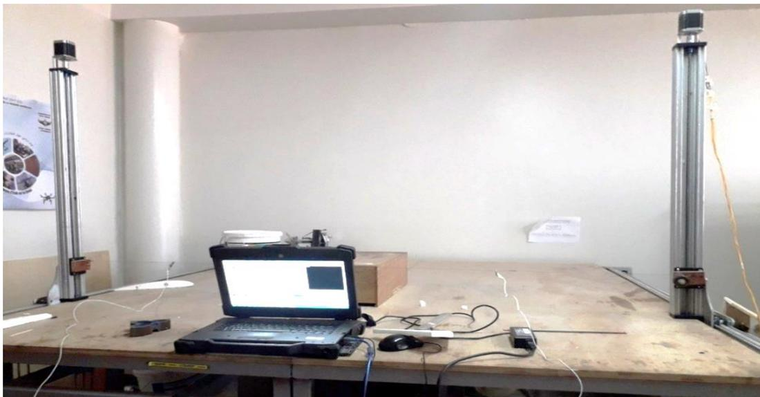
Figure II.7. Machine de découpage à fil chaud.
