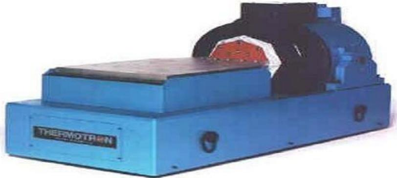
Figure I.15. Excitateur Électrodynamique.
