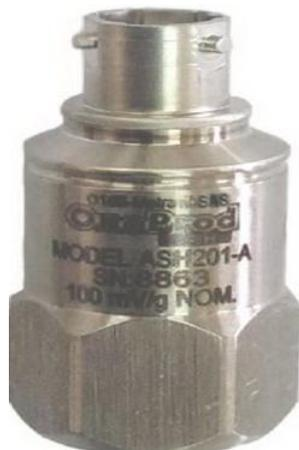
**Figure 3.8 [14]** Accéléromètre piézoélectrique
