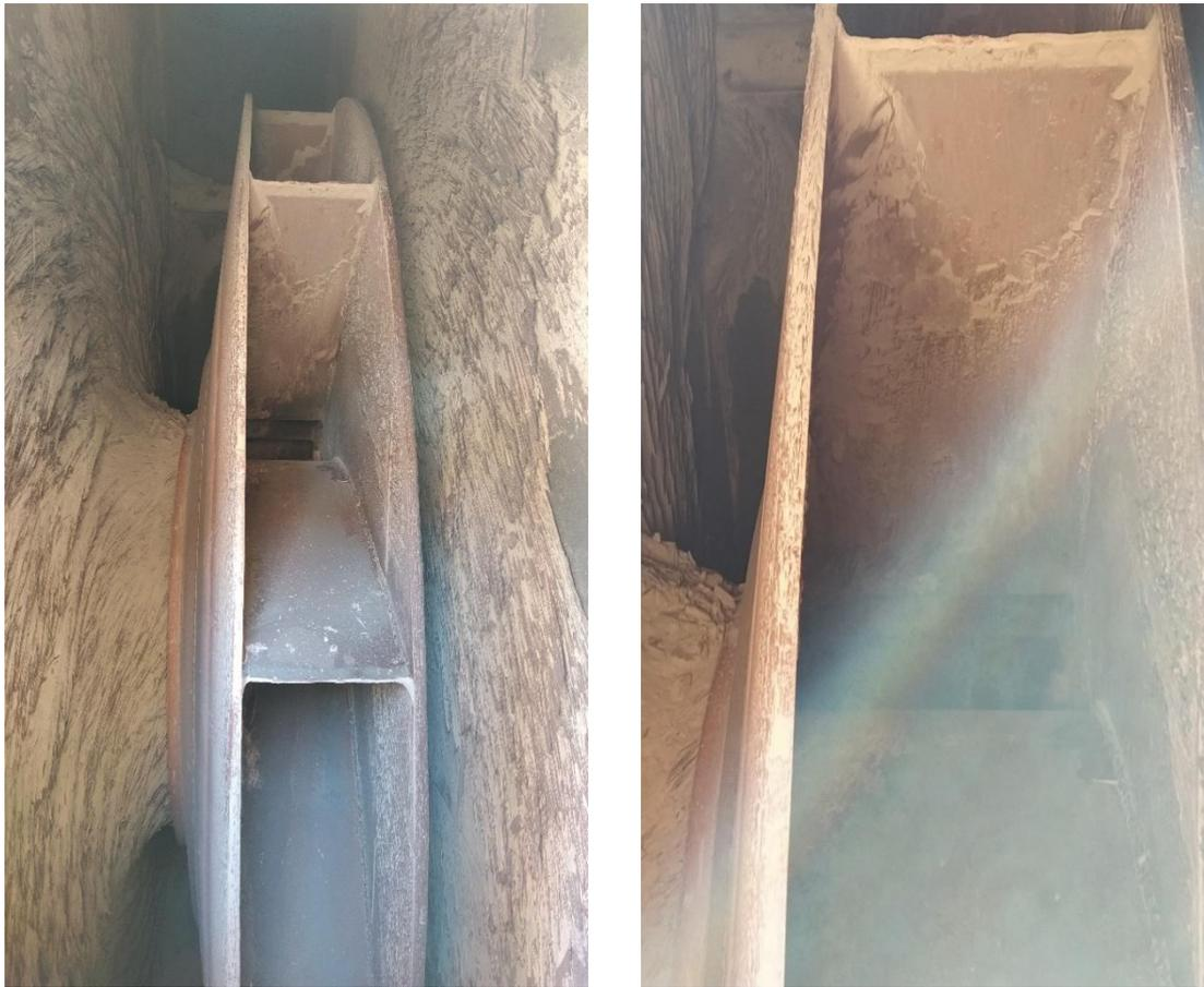
**Figure 3.29** Colmatage de la matière sur la turbine
