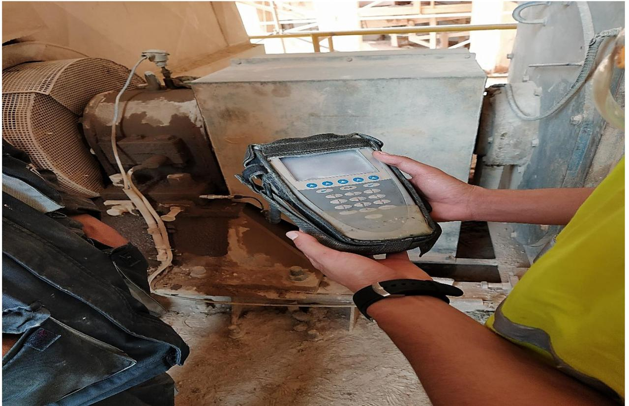
Figure 3.16 Enregistrement des mesures sur le palier N°3
