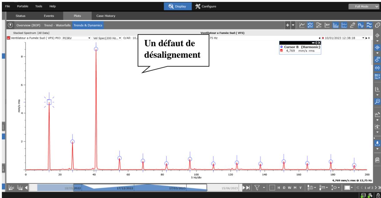
**Figure 3.20** Spectrale linéaire (basse fréquence (0-200) Hz) prise sur le palier N°3 en direction verticale, illustre un désalignement.
