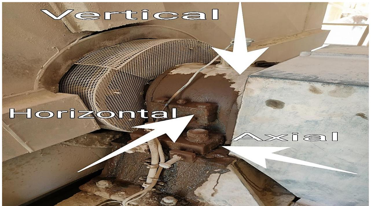
**Figure 3.15** Les positions de mesure sur le palier N°3
