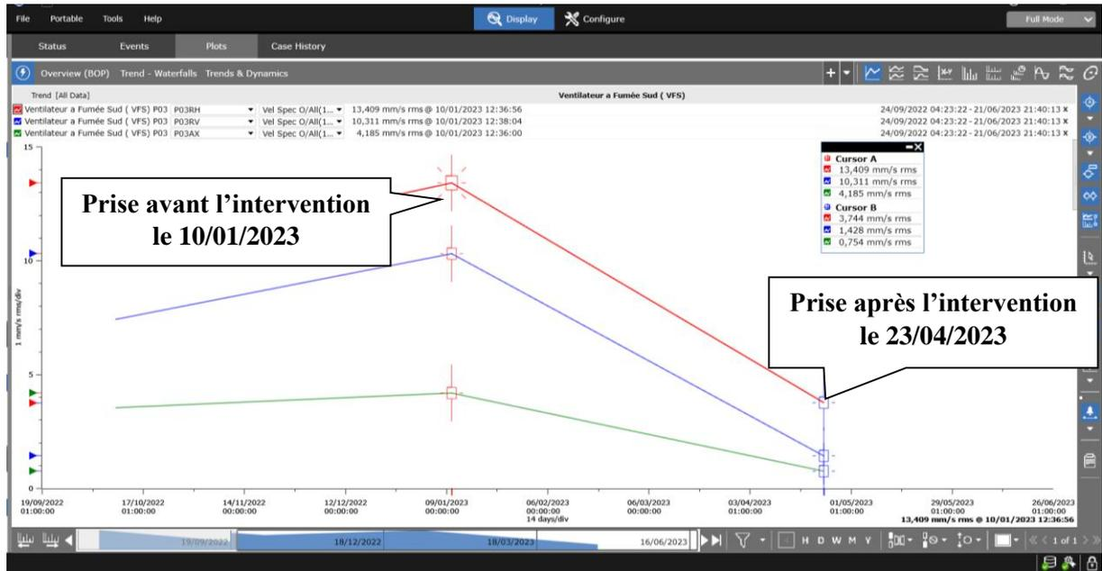
**Figure 3.38** Courbe de tendance sur le palier N°3 de la turbine en trois directions (H, V, A), illustrant le décroissantes du niveau vibratoire en vitesse « mm/s ».
