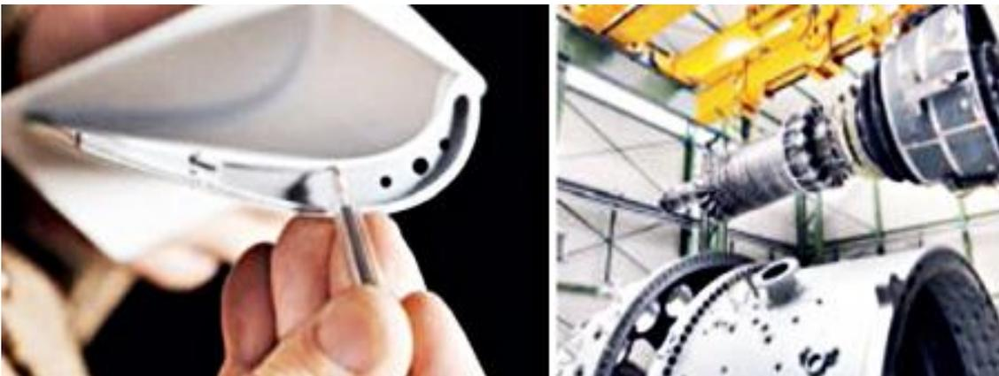
*Fig. (I.11) : À droite l'axe de moteur qui comprend le rotor du compresseur et au-dessous la partie fixe qui comprend le stator et le carter de moteur, et à gauche vue de profil d'une ailette (blade).*
