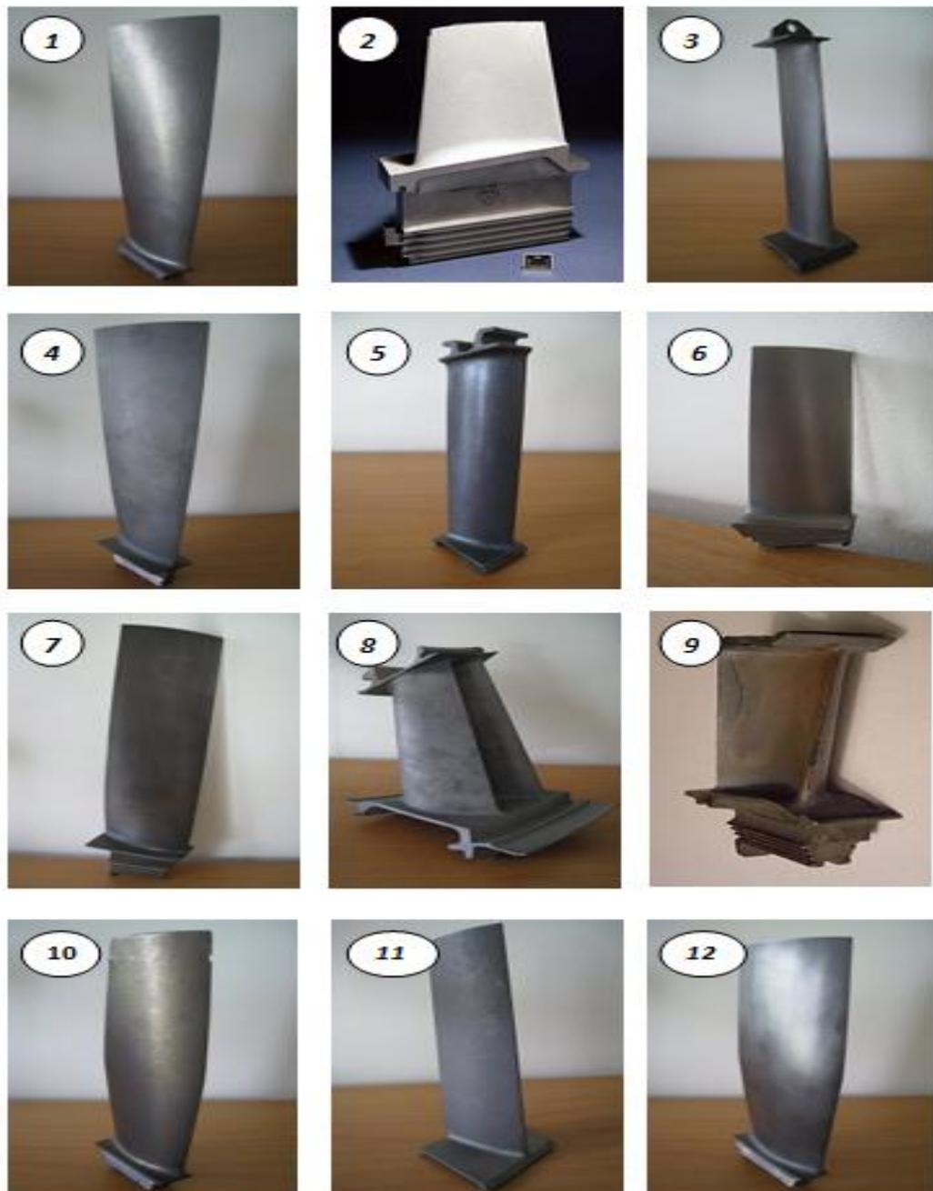
*Fig. (I.23) : Différents types d'ailettes du compresseur du moteur Concorde Olympus 593*
