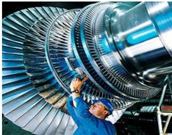
*Fig. (1.9) : Un employeur qui vérifie la fixation des ailettes dans la turbine.*
