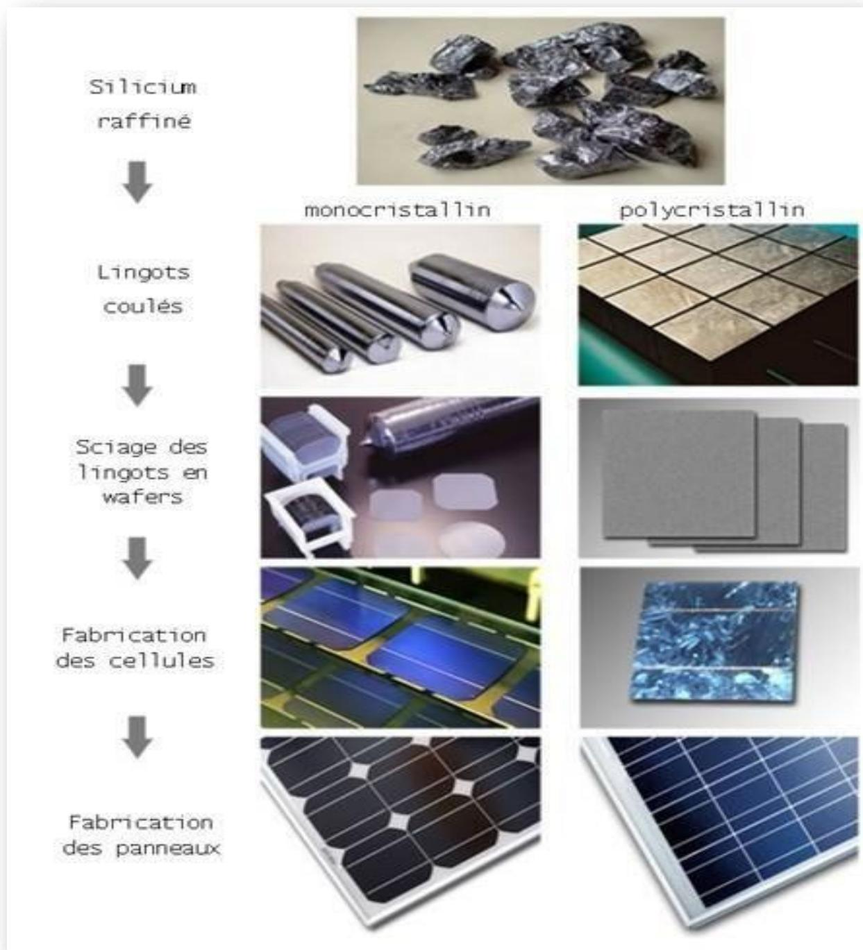
**Figure (I.29) :** Résumé des étapes de fabrications des cellules cristallines (monocristallines et poly cristallines)
