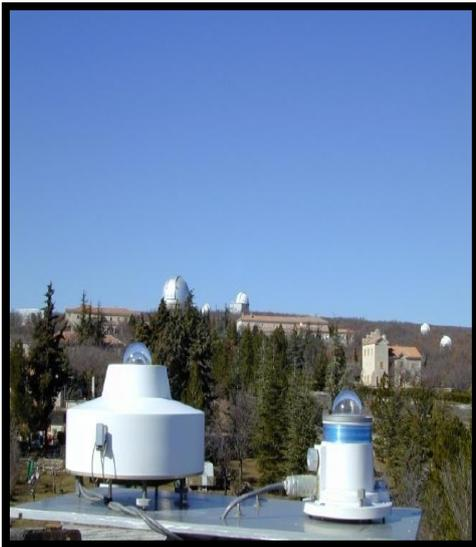
**Figure (I.10) :** Pyranomètre
