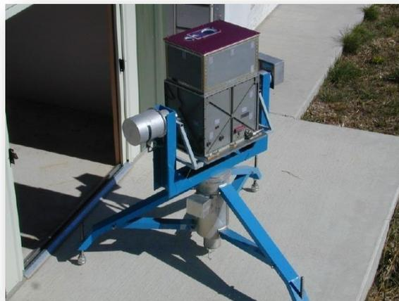
Figure (I.6) : Spectromètre SOSP
