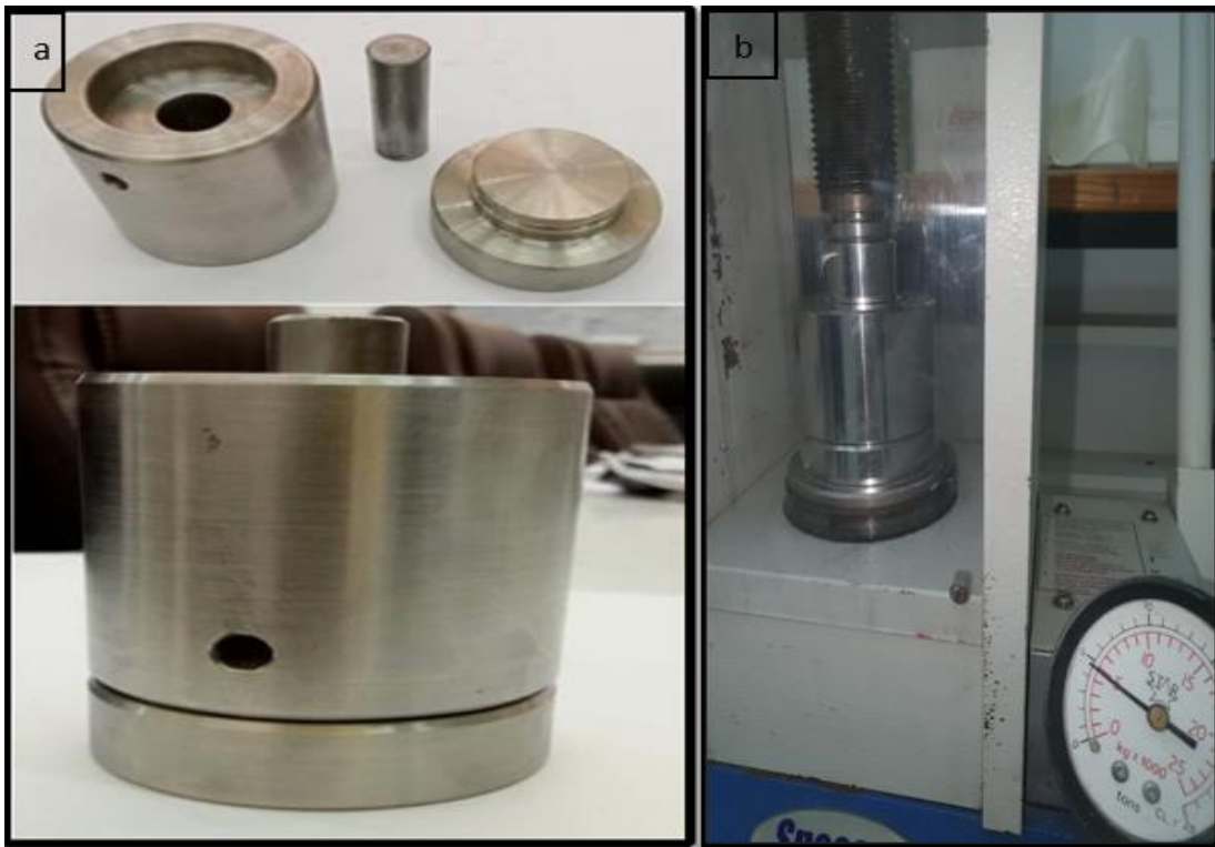
Figure III. 3: a : Dispositif de compactage, b : SPECAC PRESS 25 TON
