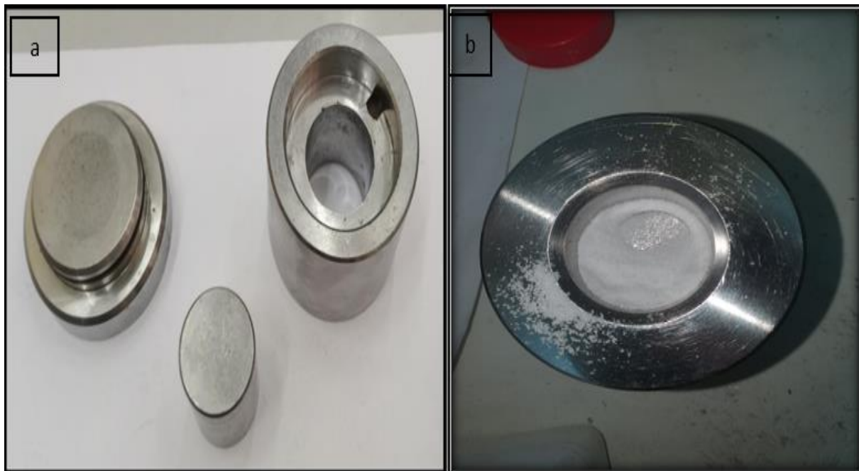
Figure III.5 : a : Dispositif d'encapsulation 32 mm, b : Dispositif d'encapsulation 32 mm avec le KCL
