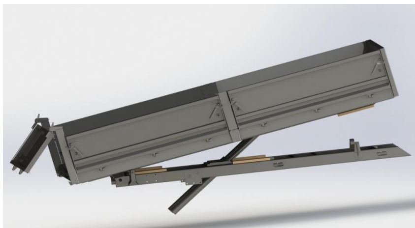
Figure 21: La caisse transporteuse sur k120.
