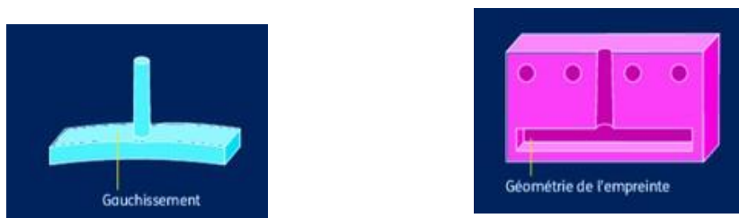
Figure(III.16):Gauchissement due à une mauvaise conception du moule
