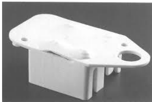
Figure(III.15):Effet diesel due à une mauvaise conception du moule
