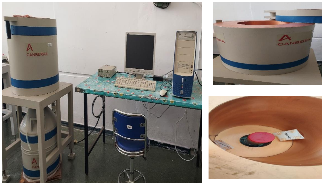
FIGURE III.5: CHAÎNE DE SPECTROMÉTRIE GAMMA AVEC LE DÉTECTEUR À SEMI-CONDUCTEUR GE (HP).
