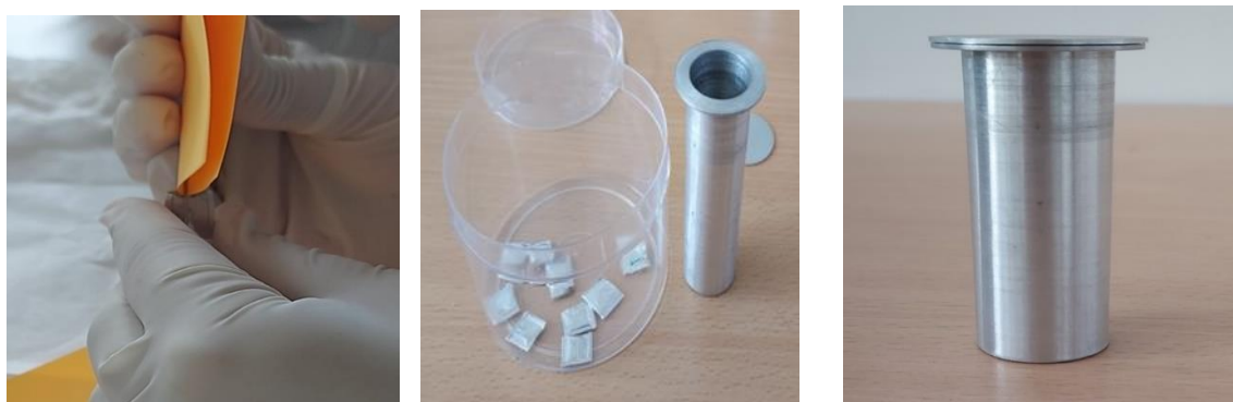
FIGURE III.4 : REMPLISSAGE D'ÉCHANTILLON DANS UNE ENVELOPPE EN ALUMINIUM APRES EN CAPSULE.
