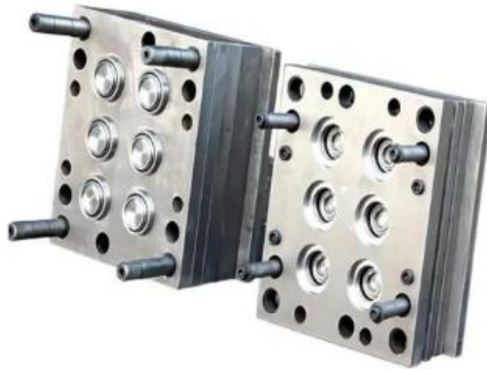
Figure III.4: Moule d'injection de métal en alliage d'aluminium.
