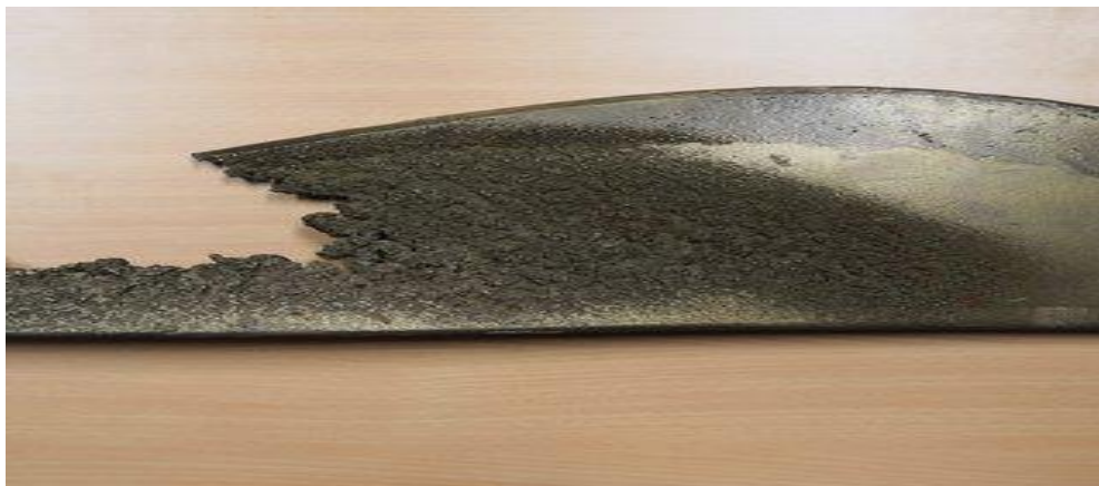
Figure 1- 4: Érosion par cavitation du côté pression de la pointe d'une pale d'hélice
