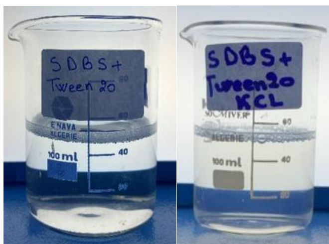
Figure IV.11. Aspect de la solution du système mixte SDBS-TWEEN 80 avec (Droite) et sans KCl (Gauche) à 5wt%
