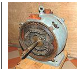
Intérieur d'une machine asynchrone diphasée, R. Alioth et Cie, no 1042, vers 1893
