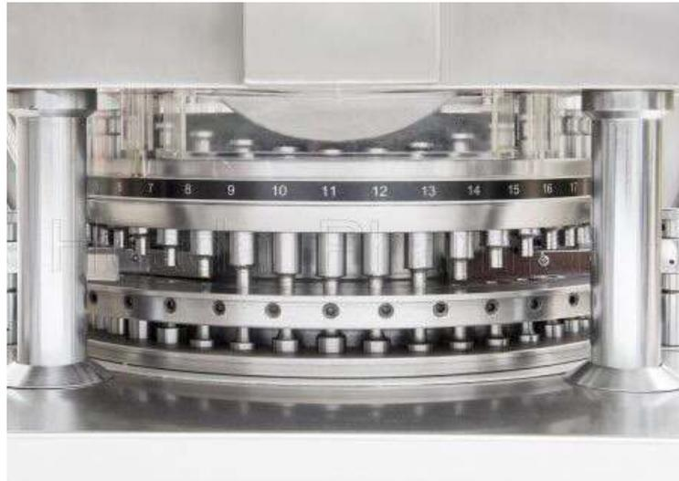
**Figure I.2:** Presse à comprimé
