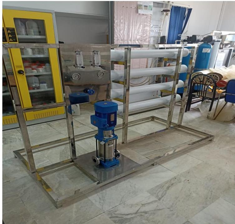
**Figure III.20** : Présentation du système d'osmose inverse réalisé.
