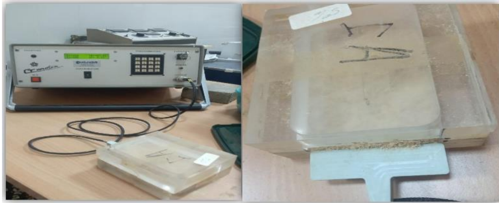
Figure II. 4 : Mesure de la conductivité thermique des échantillons en poudre.
