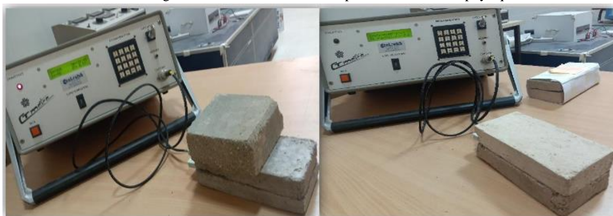
Figure II. 3 : Mesure de la conductivité thermique des éprouvettes.
