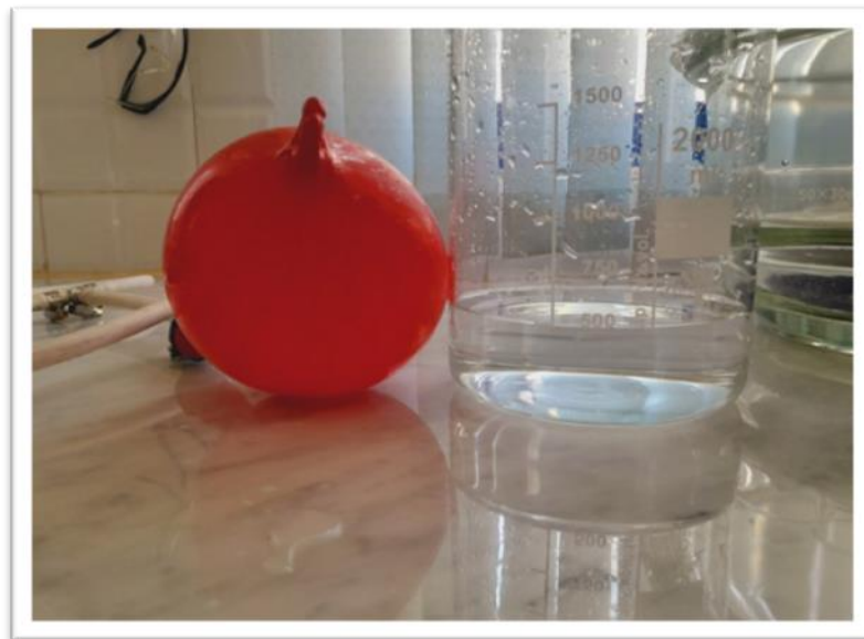
Figure N°3.11:méthode de calcule de volume de biogaz produit
