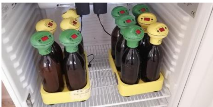
Figure N°6.1: Appareil de mesure de DBO5 [50]
