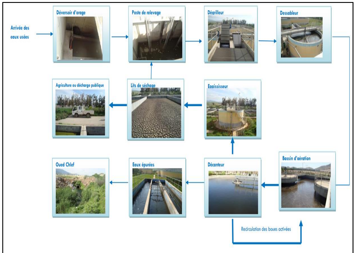
Figure N°2.1 : Schéma synoptique de la STEP de AIN DEFLA. [55]
