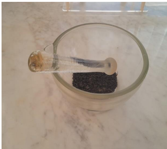
Figure N° 2.2 : broyage des boues
