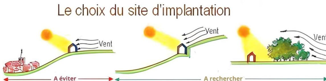
Figure I. 8 : Méthodologie d'implantation d'un bâtiment
