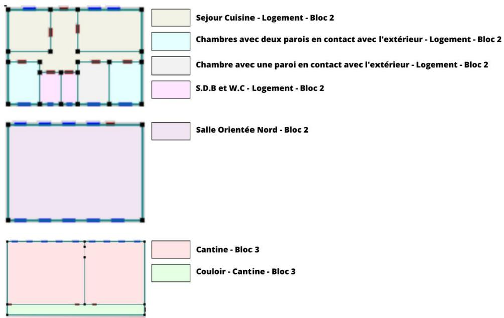
Figure III. 21 : Zones thermiques bloque 2 et bloc 3
