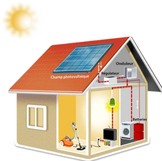
Figure I.6 Les différents composants d'un système photovoltaïque autonome.
